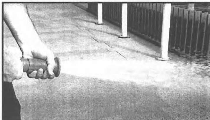
5. Sujetar la lanza – boquilla y dirigir el chorro hacia la base del fuego.
